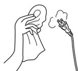
湿気などで絶縁不良になり火災・感電の原因となります。電源プラグを抜き、乾いた布でふいてください。
