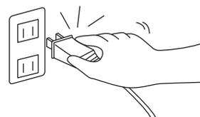
コードを引っばると、コードが破損し、感電・ショート・火災の原因となることがあります。
