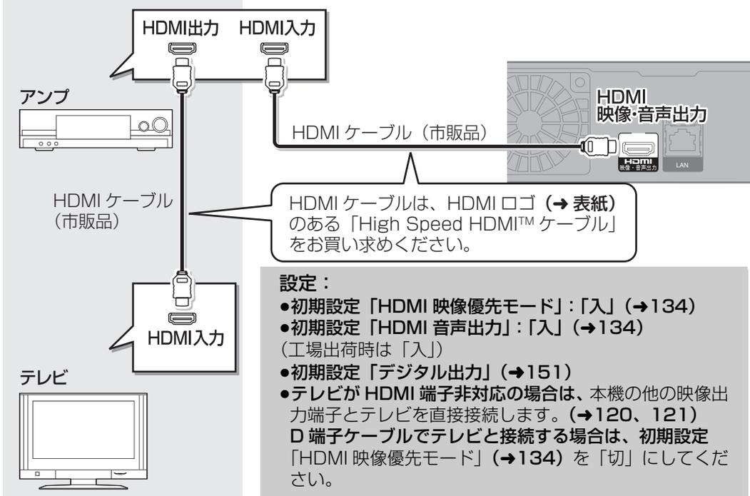
本機をピエラリンク(HDMI)に対応した当社製テレビとアンプにHDMIで接続すると、本機の音声出力先を切り換えることができます。(→19)
