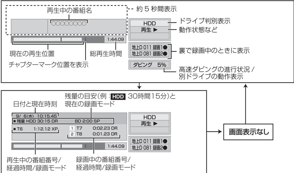
●撮影日時が記録されたハイビジョン動画 (AVCHD) を本機で記録した場合、画面の左下に撮影日時が表示されます。(1 倍速ダビング時を除く) ただし、撮影した機器によっては表示されない場合があります。<br>●残量表示について<br>放送信号によってディスクの使用量にばらつきが生じるため、記録可能なおおよその時間を表示しています。(DRモードでは、特にそのばらつきが大きくなります) |
